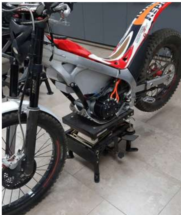
Cota 49cc amb motor de 12 kW i 4 marxes amb una bateria de 3 KWh
